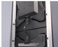
2. 连接电源信号线 ;
