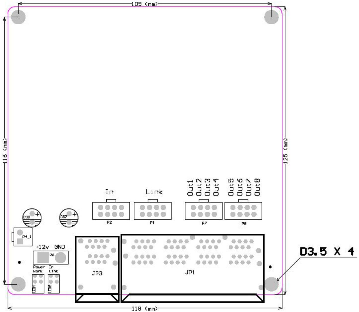
注: 定位孔直径 3.5 (mm), 可用M3螺丝。
